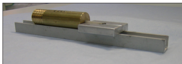
Ryc. 2. Wkład FRC podczas cementowania umieszczony na pryzmie. Widoczny gwint zewnętrzny na końcu tulei.
