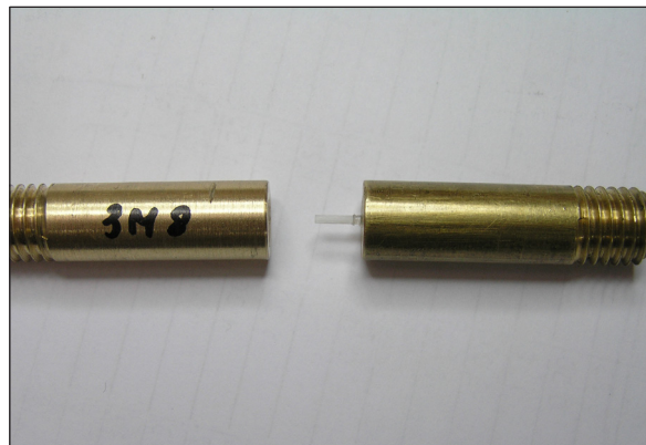
Ryc. 5. Próbkę po teście ścinania (zerwana prawidłowo).
